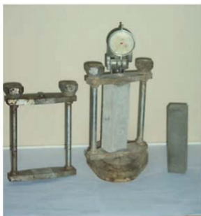
Рис. 1. Определение самонапряжения в динамометрическом кондукторе
